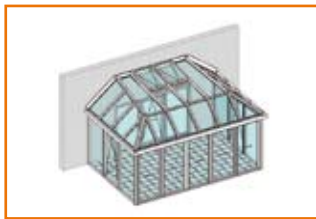
Pultdach mit Solarknick und seitlicher Abwalmung
